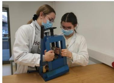
Zwei junge Forscherinnen pressen aus selbst hergestelltem Eisenschwamm eine Tablette, die anschließend zu Grünem Stahl erschmolzen wird („Schüler experimentieren“-Projekt
